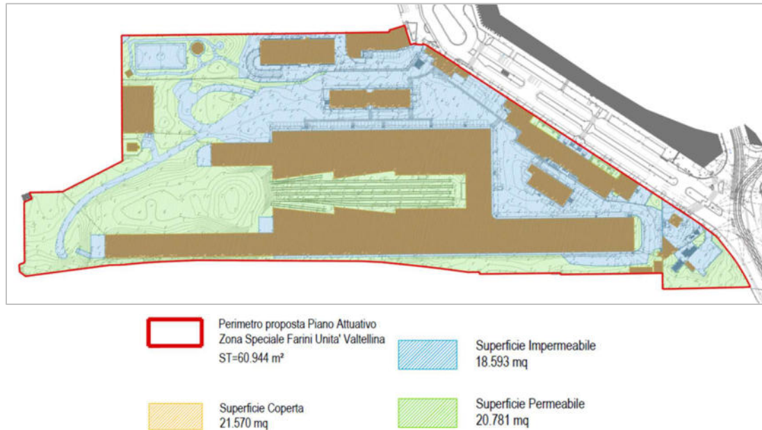
Figura 3.5: Schema superficiale filtrante relativa allo stato di fatto
