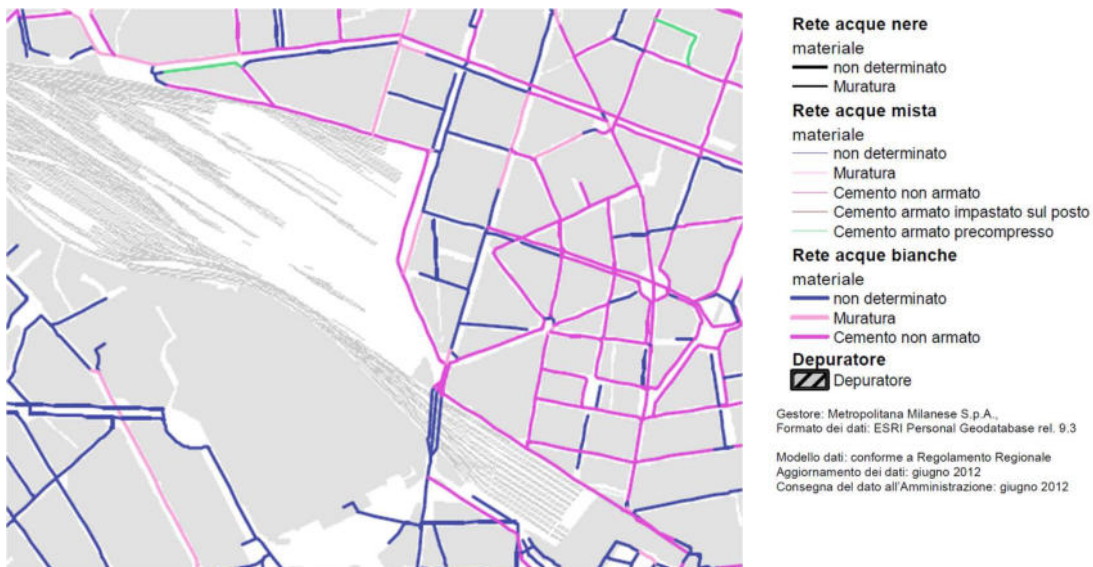
Figura 4.53: Rete acque reflue nel territorio di interesse (Fonte: PUGSS Tav.01.a - Sistema servizi a rete)
