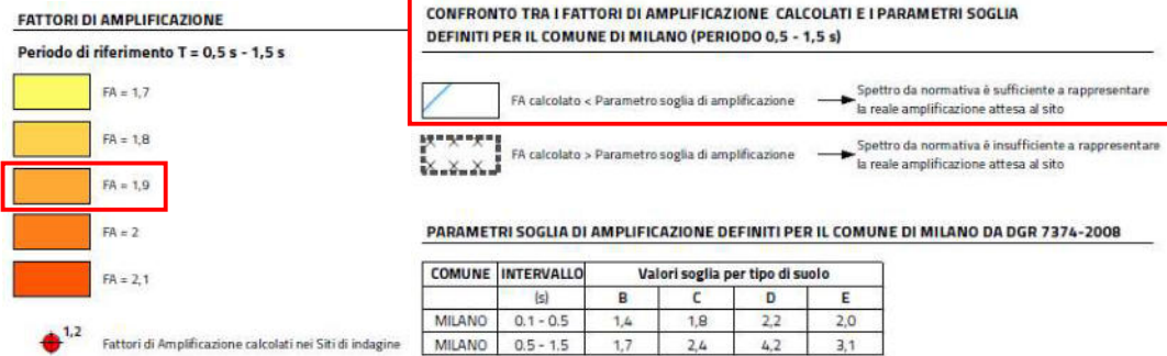
Figura 3.23: Estratto Carta dei fattori di amplificazione 0,5-1,5 s e di confronto tra Fa calcolati e Fa da normativa della componente geologica del PGT Milano2030 (CG G12) - ottobre 2019
