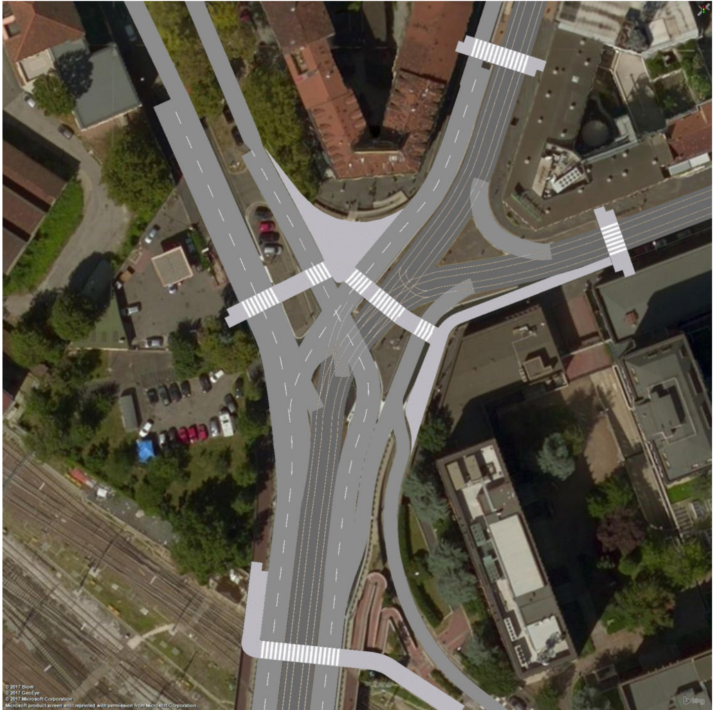
Schema del modello del nuovo layout proposto, nella ersione con attraversamento pedonale sul ponte di via Farini
