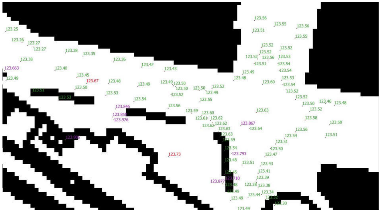
Figura 5.3 – Particolare via Pepe angolo via Cola Montano: confronto tra quote topografiche COIMA (in verde), quote topografiche STID (in viola) e quote AEF (in rosso)
