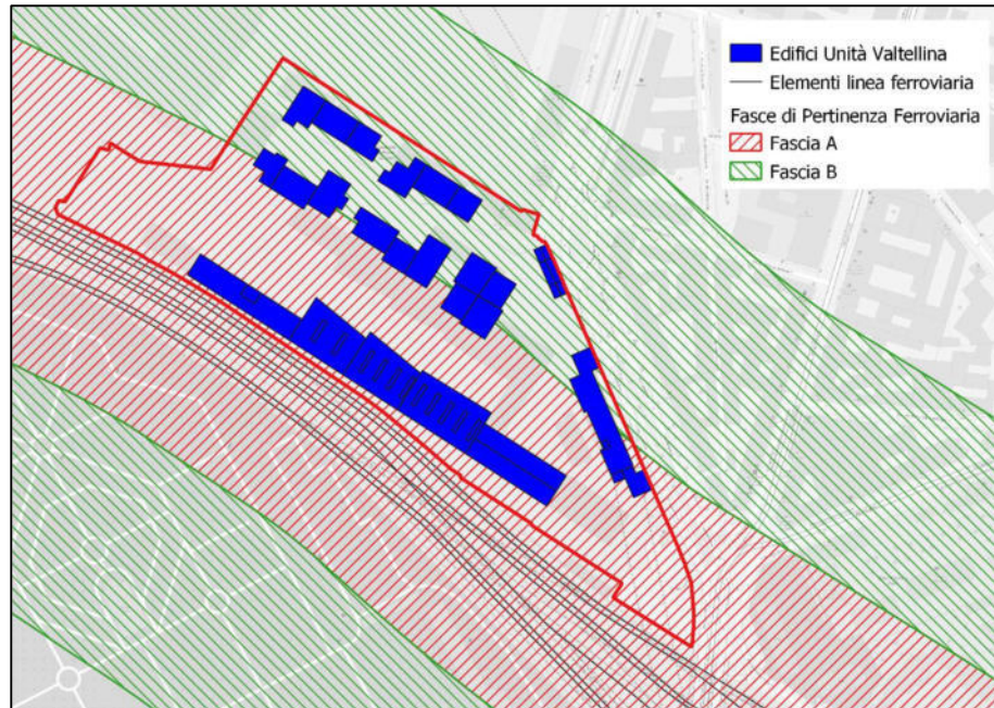
Figura 4.4: Tracciamento Fasce di Pertinenza acustica ferroviaria
